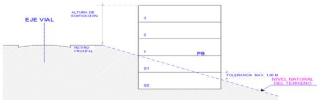
Gráfico N° 6c Edificaciones Sobre Plataformas Aterrazadas: en Pendiente Positiva
