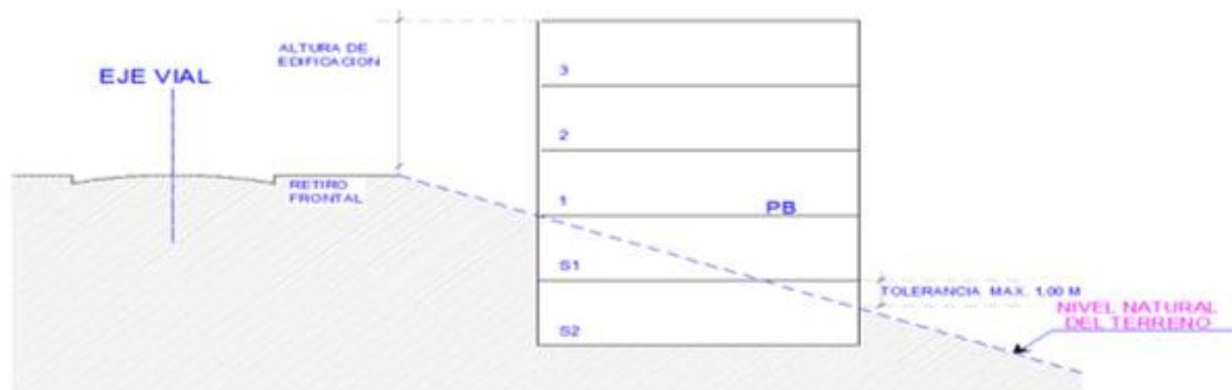
Gráfico N° 14 Edificaciones Sobre Plataformas Aterrazadas: en Pendiente Positiva
