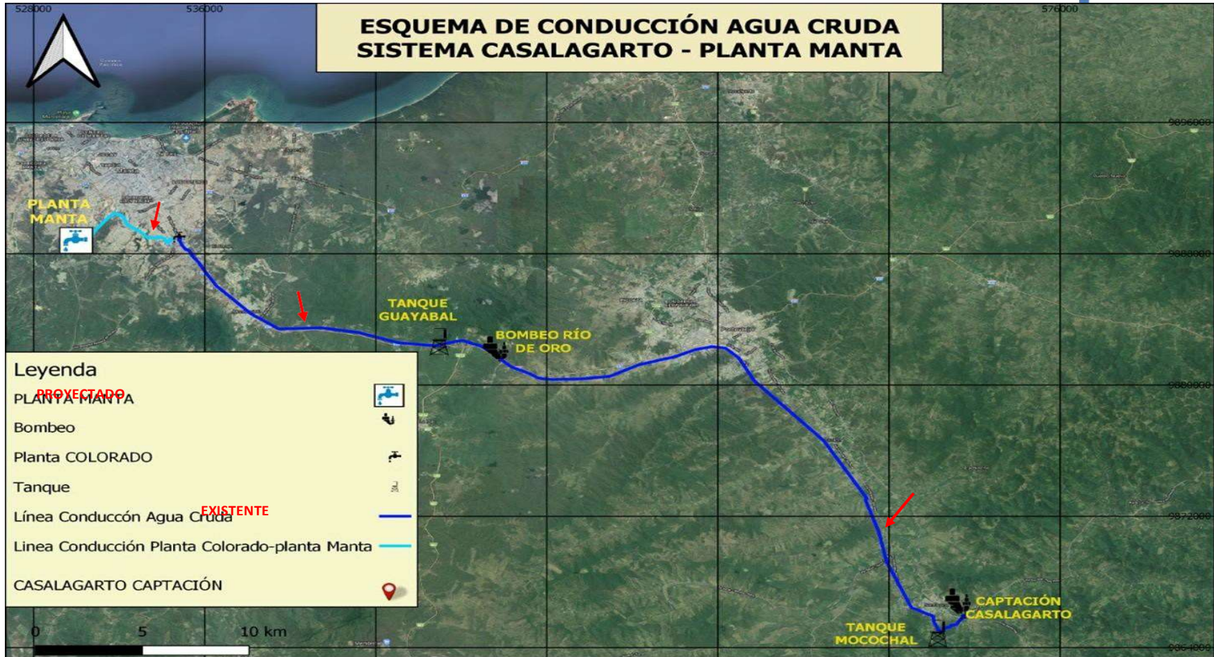
Gráfico 4. Esquema de conducción agua cruda Sistema Caslagarto-Planta Manta
