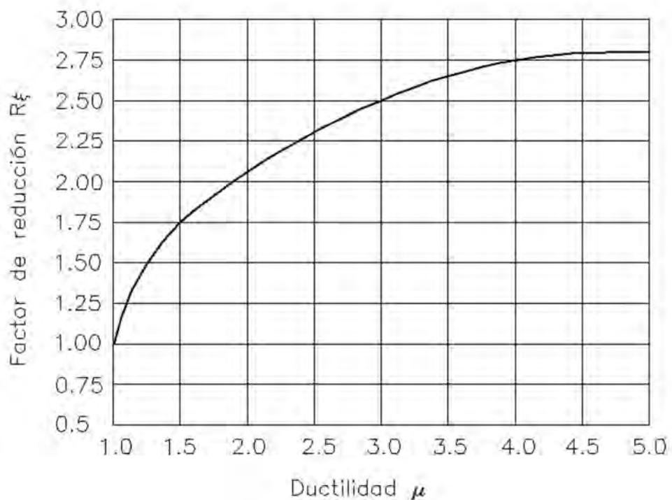
Figura 69: **Factor de Reducción de la Demanda Sísmica**
