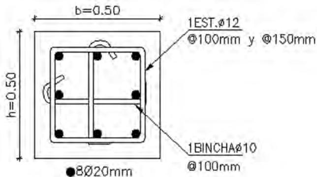
Figura 75: Vista en planta de columna diseñada
