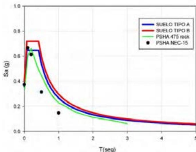
Figura 38: **Comparación de los espectros de diseño según la NEC-15, espectro de peligro uniforme estimados mediante estudios probabilistas locales, valores espectrales para el mismo periodo de retorno (475 años) considerando las curvas de peligro sísmico de la NEC**
