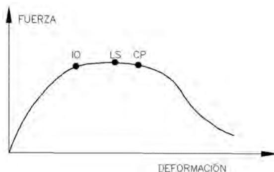
Figura 61: **Capacidad de deformación para diferentes niveles de desempeño**
