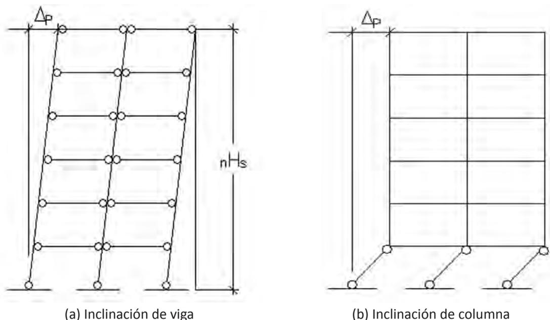
Figura 65: **Mecanismos de respuesta inelástica en pórticos**
