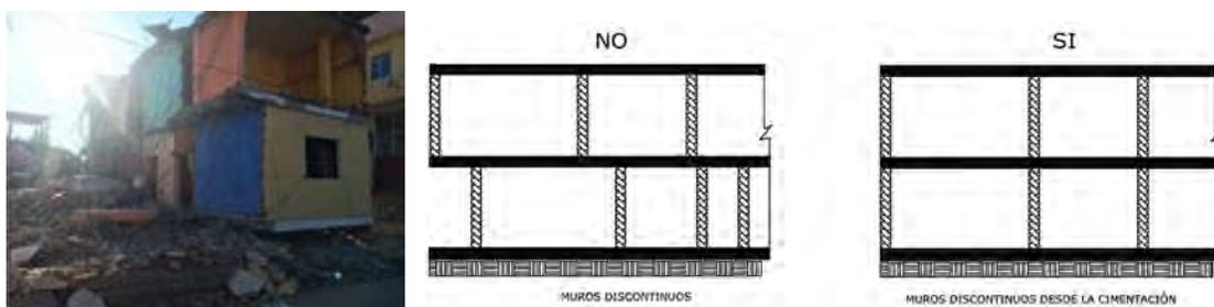
Figura 18: **Continuidad de elementos estructurales**
