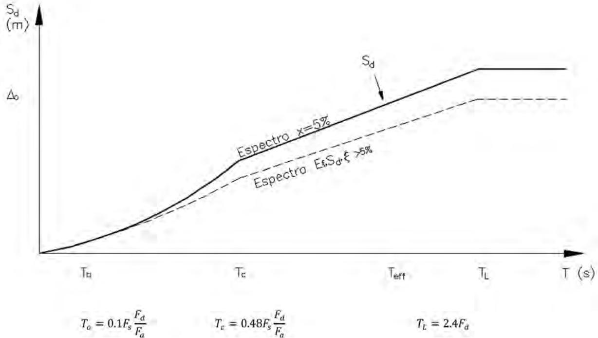
Figura 70: Periodo efectivo de Sistema equivalente de un grado de libertad
