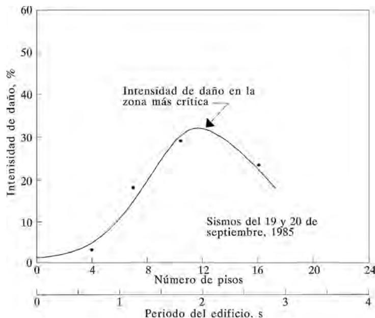
Figura 35: **Efecto del tipo de suelo en la intensidad de daños a edificios. México Septiembre 19, 1985 (Seed y Sun, 1989)**
