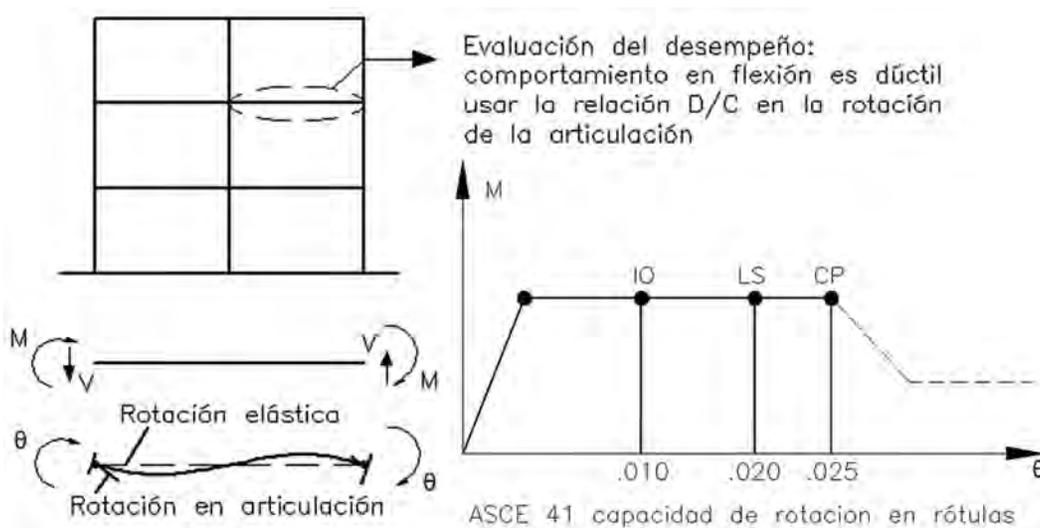
Figura 59: Diagrama Momento Curvatura para el Hormigón
