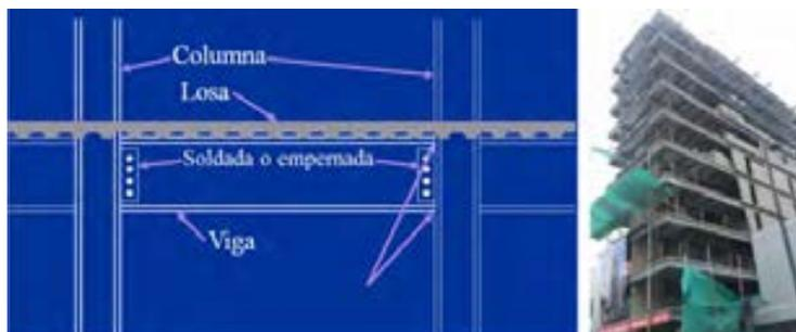
Figura 121: Tipo de sistema estructural: Pórtico de acero laminado (S1).
