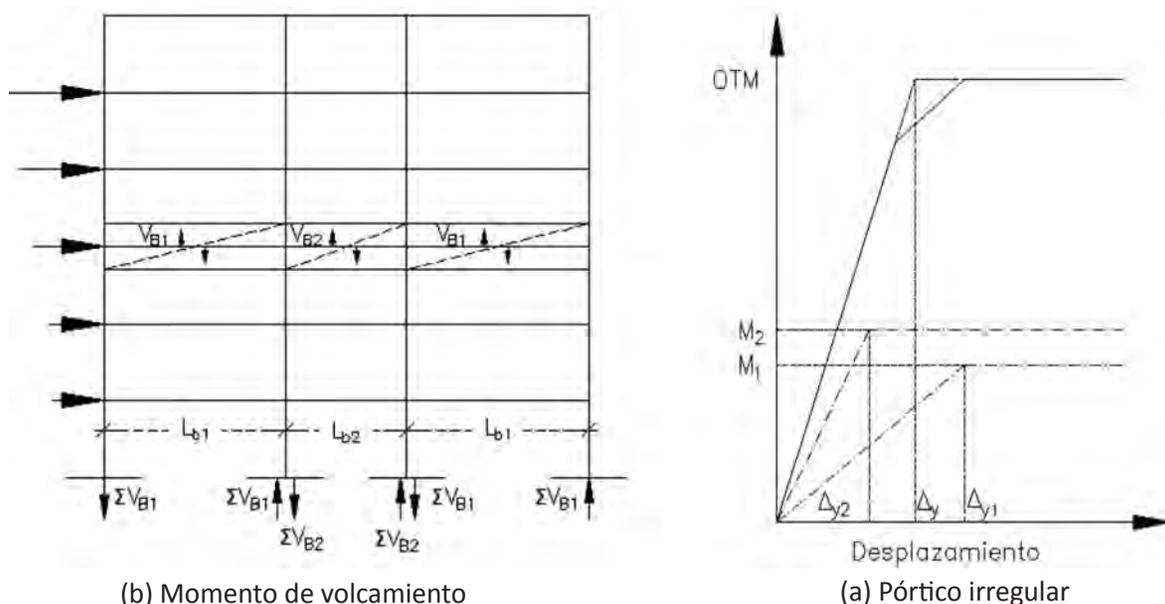
Figura 68: **Respuesta sísmica de un pórtico irregular**
