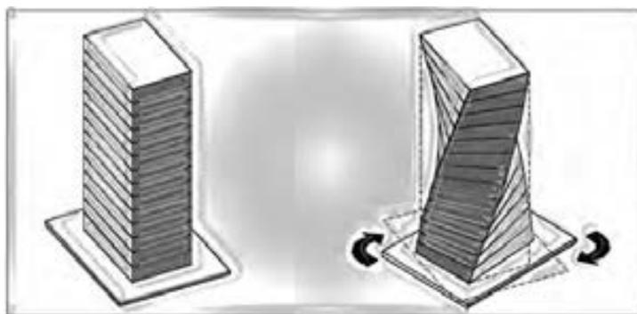
Figura 13: **Torsión debido a no coincidencia de centro de rigidez y centro de masa**
