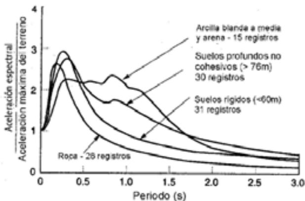
Figura 37: **Espectros de respuesta medio normalizados (5% amortiguamiento) para diferentes condiciones locales de sitio. (Seed et al.,1976)**
