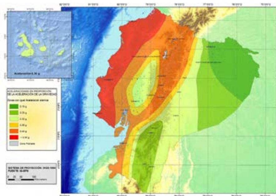
Figura 86: Zonas sísmicas para propósitos de diseño
