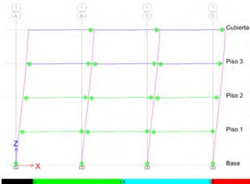
Figura 77: **Primeras rótulas plásticas en columnas-Seguridad de Vida-paso 10**
