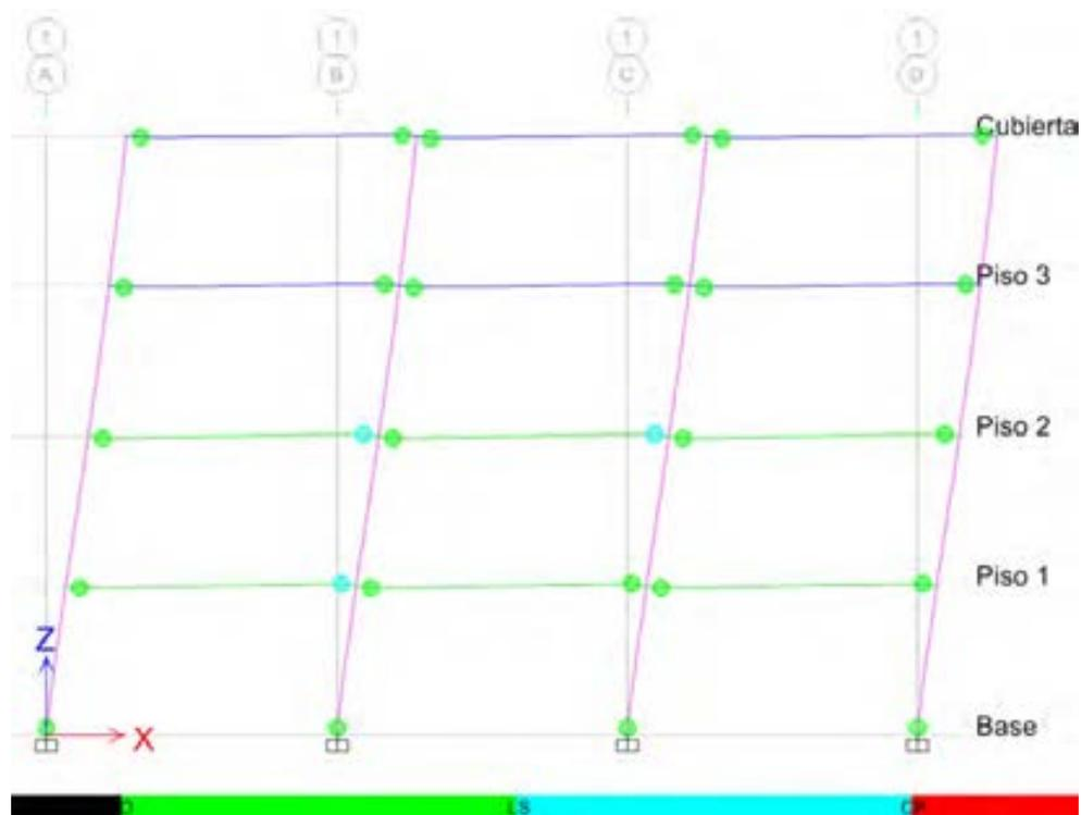
Figura 78: **Primeras rótulas plásticas en vigas-Prevención de Colapso-paso 14**
