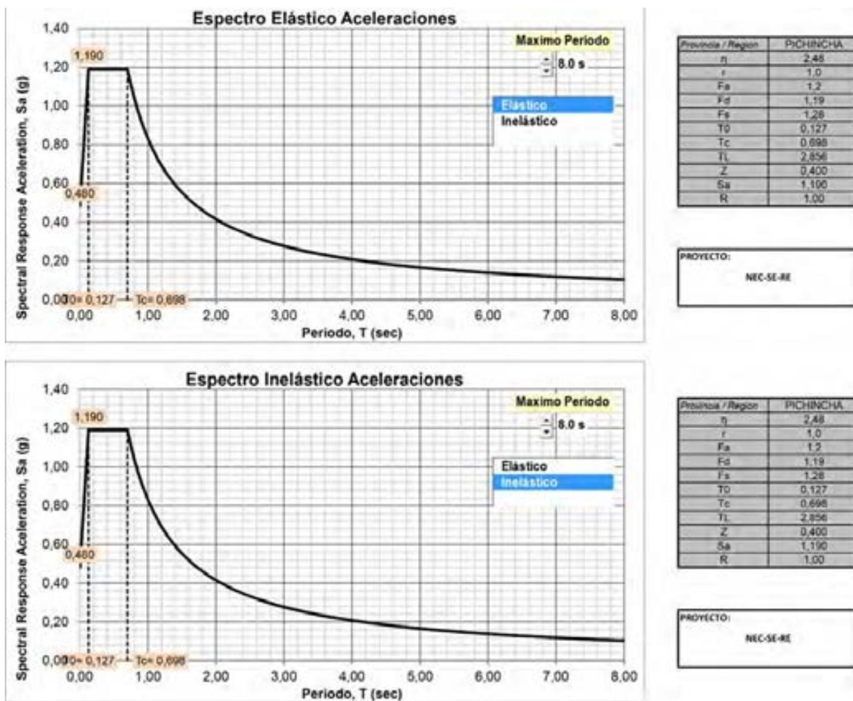
Figura 90: Adobe: espectro elástico e inelástico de aceleraciones
