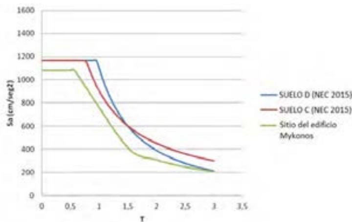
Figura 150: **Ejemplo 1: Espectros generados en SISQuito 1.2 vs. Espectros NEC 2015**
