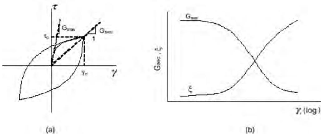
Figura 42: **a) Curva esfuerzo-deformación cíclica b) curva del módulo de rigidez secante al corte y amortiguamiento histerético variando con la deformación unitaria al corte**
