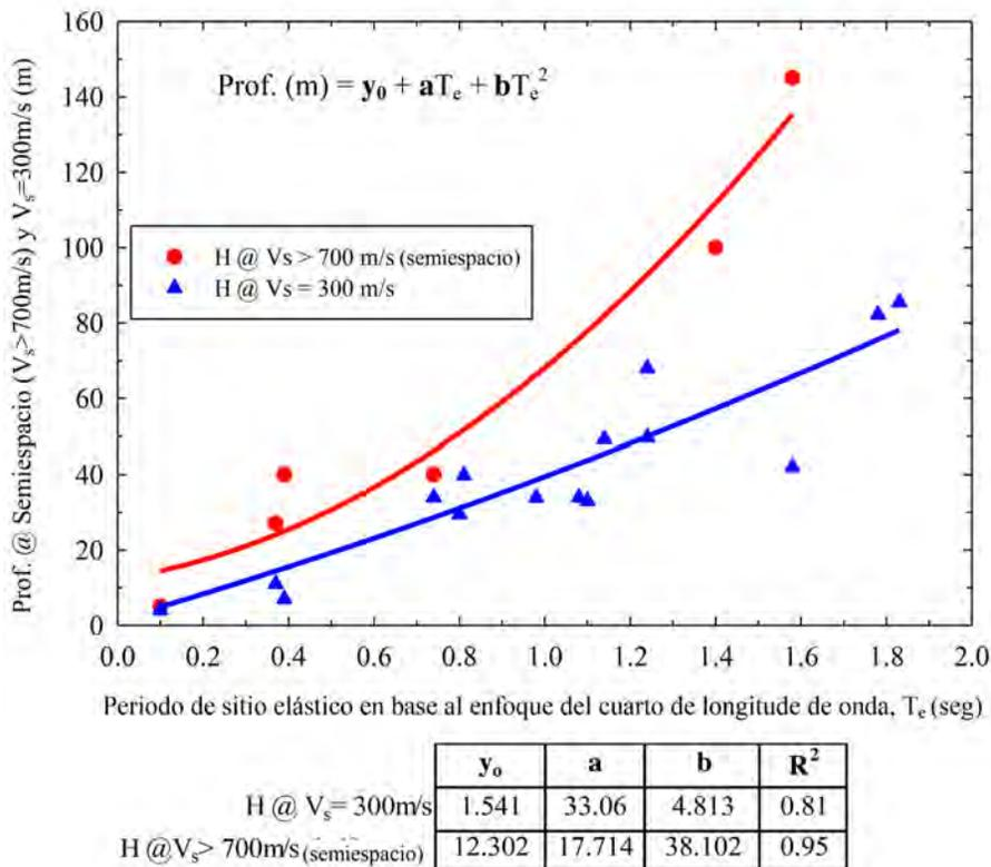
Figura 41: **Curvas de tendencia entre la profundidad del semiespacio – período elástico (curva roja) y la profundidad donde  $V_s=300$  m/s – período elástico (curva azul) para la Ciudad de Guayaquil (Vera, X, 2014)**
