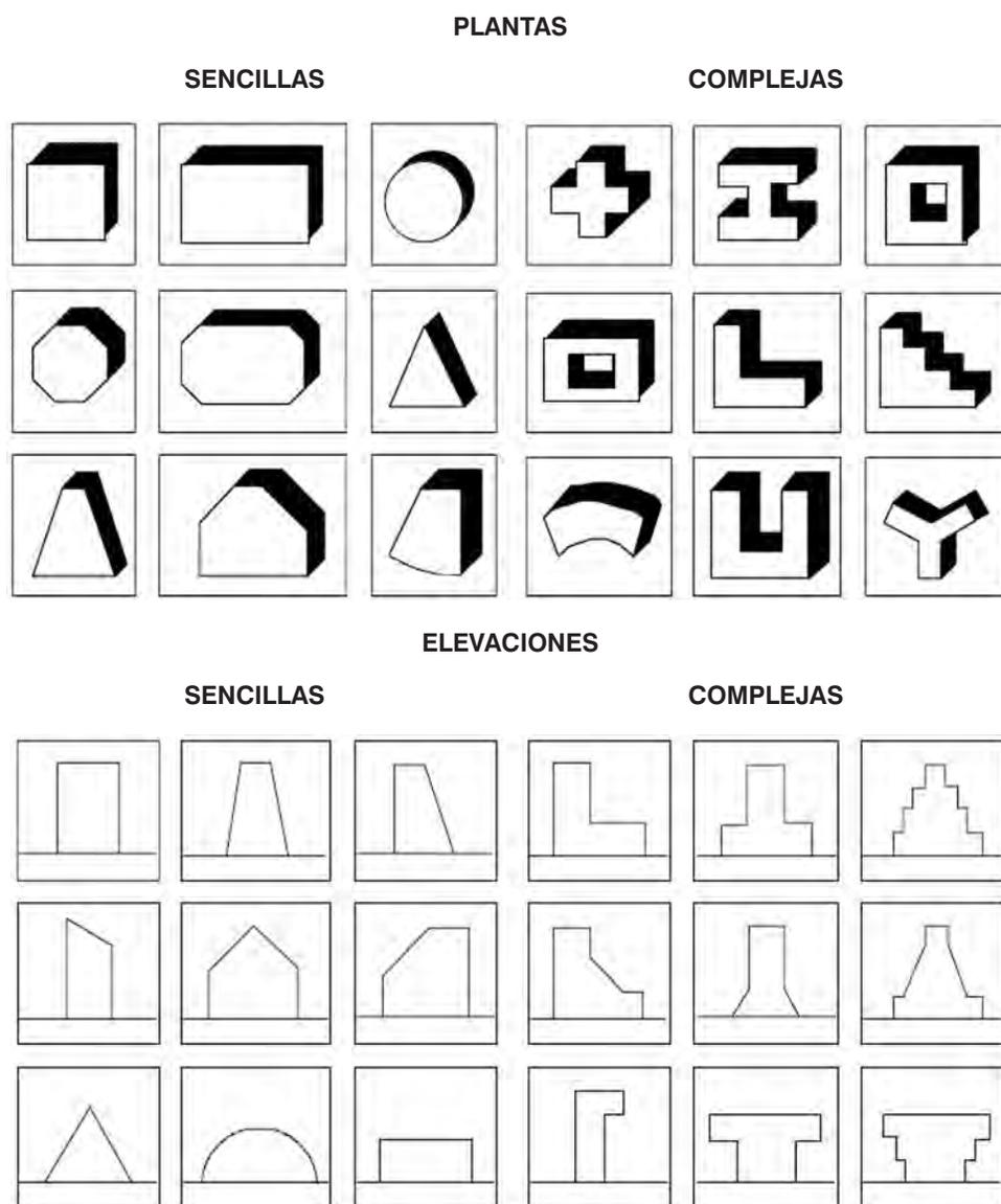
Figura 1: Configuraciones estructurales en planta y elevación
