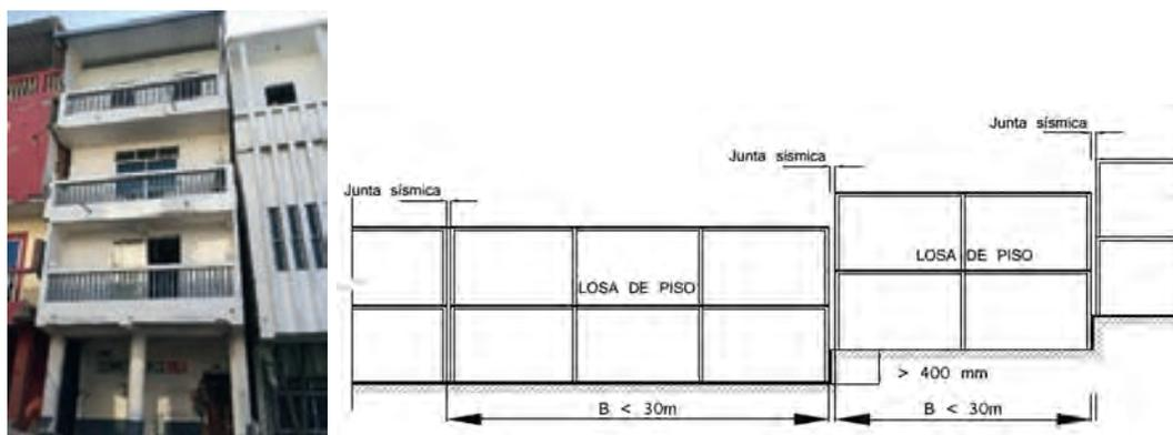
Figura 4: **Longitud excesiva en planta: juntas de construcción**
