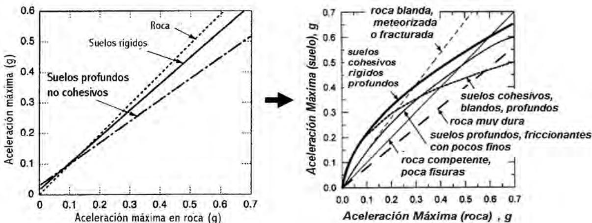
Figura 36: **Relación aproximada entre la aceleración pico en roca y otros tipos de condiciones locales de sitio, propuesta por Seed et al., 1976 (figura izquierda) y modificado de Seed et al, 1997 (figura derecha)**
