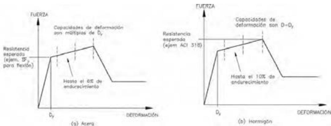
Figura 58: Modelos para Acero y Hormigón
