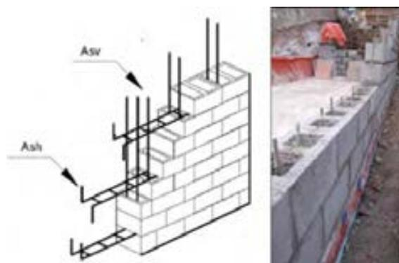
Figura 115: Tipo de sistema estructural: Mampostería reforzada (RM).
