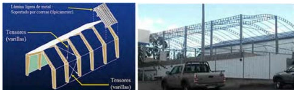
Figura 123: Tipo de sistema estructural: Pórtico de acero doblado en frío (S3).
