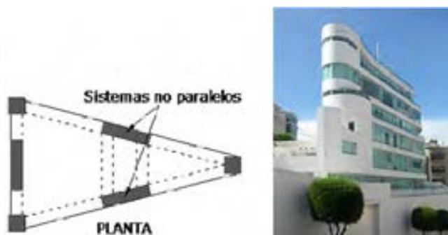
Figura 139: Irregularidad en planta: ejes estructurales no paralelos
