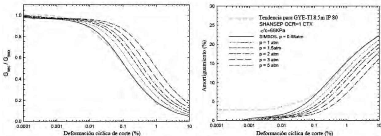
Figura 43: **Comparación del módulo de reducción y curva de amortiguamiento de la tendencia de los ensayos cíclicos para GYE-TI a un esfuerzo de consolidación de 0.68 atm y la simulación del modelo para diferentes esfuerzos de confinamiento (Vera, X, 2014)**
