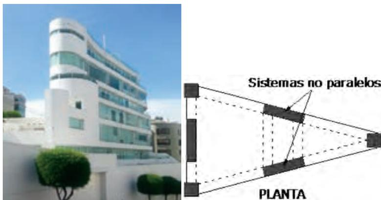
Figura 9: Ejes estructurales no paralelos
